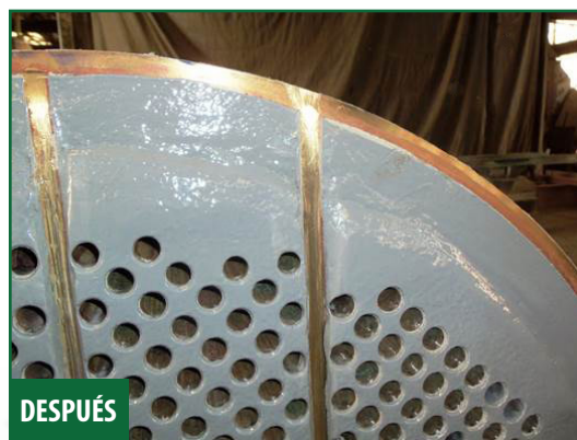
Lámina de tubo revestida con Novocoat EP5700 Ceramic Paste .
